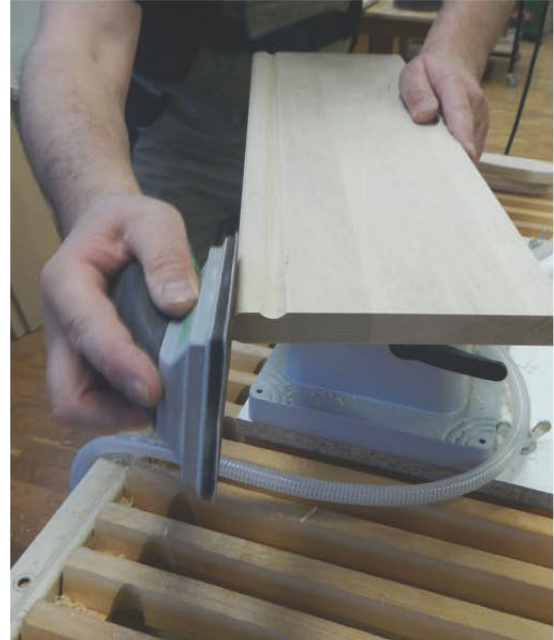
Aufgrund seiner geringen Abmessungen und des geringen Gewichtes ist der Handschleifklotz sowohl für den stationären als auch für den mobilen Einsatz geeignet.
